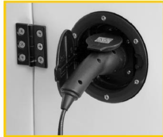
Externer Ladeanschluss offen mit eingestecktem Ladekabel
